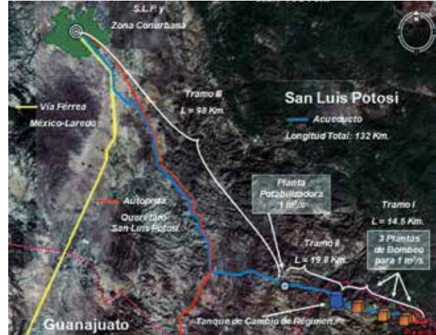
Figura 2. Secciones del acueducto El Realito
